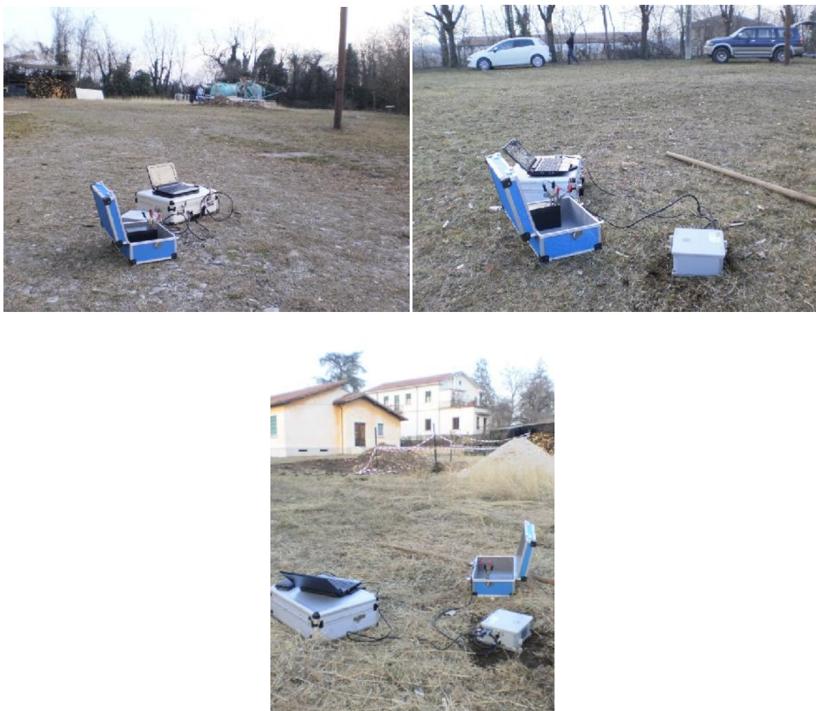
Sismografo triassiale in dotazione con sensori ortogonali da 4,5 Hz e convertitore A/D 24 bit
