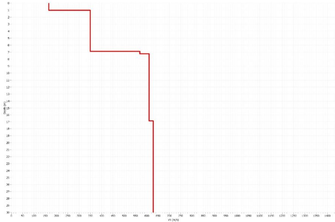
HVSR 2 Profilo di Vs mediante inversione ( curva migliore corrispondente ai valori di confidenza più bassi)
